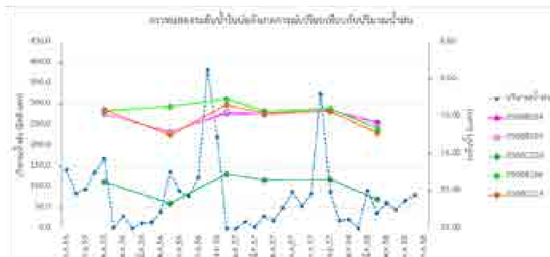
รูปที่ 3-14-1 กราฟแสดงการเปลี่ยนแปลงระดับน้ำในบ่อสังเกตการณ์เปรียบเทียบกับปริมาณน้ำฝน (ค่าเฉลี่ยจากสถานีวัดน้ำฝน อ.เมือง จ.เพชรบุรี และสถานีวัดน้ำฝน อ.หัวหิน จ.ประจวบคีรีขันธ์ ของ กรมอุตุนิยมวิทยา)
