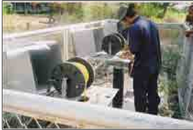
รูปที่ 2.10 การวัดระดับน้ำบาดาลโดยเทปวัดระดับน้ำบาดาลก่อนดูข้อมูล
