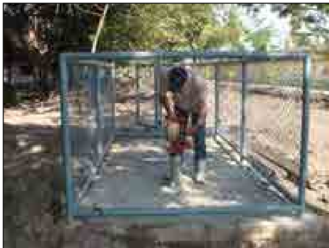
รูปที่ 2.6 การวัดระดับน้ำบาดาลโดยเทปวัดระดับน้ำบาดาล
