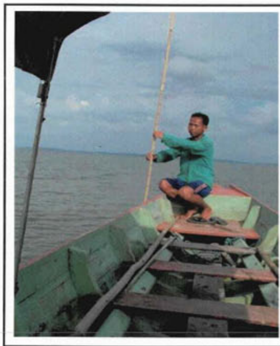
รูปที่ 6.2 การหยั่งความลึกทะเลสาบโดยใช้ไม้วัดระดับความลึกของทะเลสาบสงขลา โดยเฉพาะบริเวณใกล้ฝั่งทะเลสาบจากเรือสำรวจตะกอน ในพื้นที่ย่อยทั้ง 4 ของโครงการโดยมีระยะห่างของการวัดแต่ละจุด 200 ม. และกำหนดพิกัดโดยใช้ GPS เพื่อนำข้อมูลมาจัดทำเป็นแผนที่แสดงระดับความลึกของพื้นที่สำรวจของโครงการต่อไป
