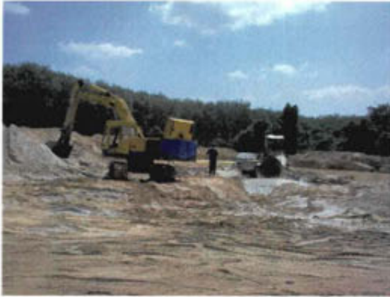
รูปที่ 7.10 การตัดทรายจากแหล่งที่สะสมตัวตามทางน้ำเก่า โดยใช้รถแบคโฮ บริเวณใกล้คลองรัตภูมิ
