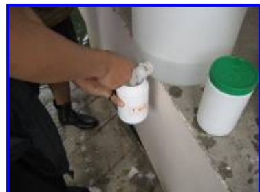
เก็บตัวอย่างสัตว์หน้าดิน โดยใช้ Grab ล้างตะกอนดินผ่านตะแกรงร่อน คองตัวอย่างด้วยฟอร์มาลิน10%
