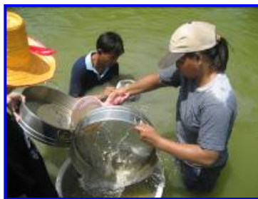
เก็บตัวอย่างสัตว์หน้าดิน โดยใช้ Grab ล้างตะกอนดินผ่านตะแกรงร่อน คองตัวอย่างด้วยฟอร์มาลิน10%
