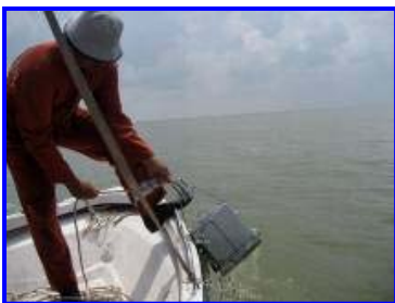
เก็บตัวอย่างสัตว์หน้าดิน โดยใช้ Grab ล้างตะกอนดินผ่านตะแกรงร่อน คองตัวอย่างด้วยฟอร์มาลิน10%
