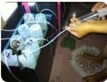
เก็บตัวอย่างดินด้วยกระบอกระบอะคริลิก (Core) นำมาทดลองการปลดปล่อยสารอาหารใน
