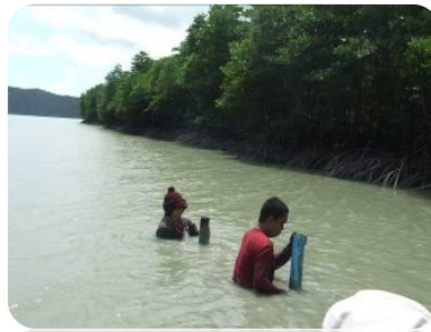
เก็บตัวอย่างดินด้วยกระบอกระบอะคริลิก (Core) นำมาทดลองการปลดปล่อยสารอาหารใน
