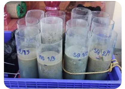
เก็บตัวอย่างดินด้วยกระบอกระบอะคริลิก (Core) นำมาทดลองการปลดปล่อยสารอาหารใน
