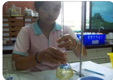
วิเคราะห์ปริมาณออกซิเจนละลายวิเคราะห์ BOD
