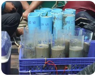
เก็บตัวอย่างดินด้วยกระบอกระบอะคริลิก (Core) นำมาทดลองการปลดปล่อยสารอาหารใน
