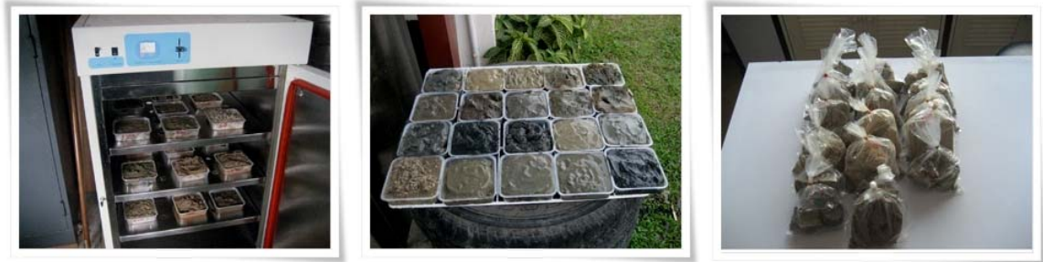
การเตรียมตัวอย่างตะกอนดินเพื่อวิเคราะห์ปริมาณสารอินทรีย์และขนาดอนุภาค
