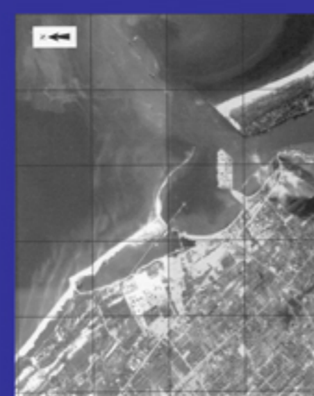
รูปที่ 3 ภาพถ่ายทางอากาศ เมื่อมีนาคม 2538 แสดงภาพทางเข้าทะเลสาบสงขลาจากทางสร้างเขื่อนน้ำลิกและเขื่อนกันคลื่น เห็นแนวสันทรายใต้น้ำและหาดทรายแก้วบนหาดทรายแก้วใต้น้ำได้ชัดเจนมากขึ้น
