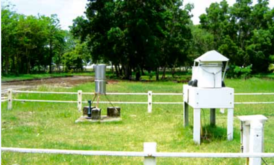
รูปที่ 22 แสดงเครื่องเก็บตัวอย่างน้ำฝน ณ สถานีศูนย์วิจัยและฝึกอบรมด้านสิ่งแวดล้อม จังหวัดปทุมธานี (ด้านขวามือคือเครื่องเก็บตัวอย่างน้ำฝนแบบอัตโนมัติ เพื่อนำไปวิเคราะห์คุณภาพน้ำฝน ซ้ายมือคือมาตรวัดปริมาณน้ำฝน)
