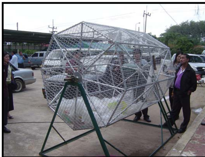
รูปที่ 6.3-1 เครื่องทำความสะอาดถุงพลาสติก เทศบาลตำบลควนเนียง
