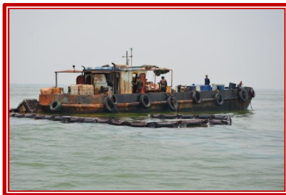
รูปที่ 42 การกู้เรือพร้อมทั้งเอาทุ่นมาล้อมคราบน้ำมัน
