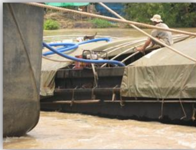
การแก้ไขผลกระทบต่อคุณภาพน้ำด้วยการเร่งสูบน้ำตาลออกจากเรือที่จม และการติดตามตรวจสอบคุณภาพน้ำ
