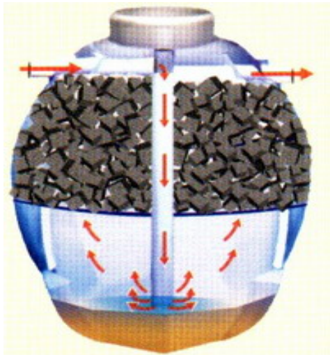
ภาพที่ ๗ ถังกรองไร้อากาศ
