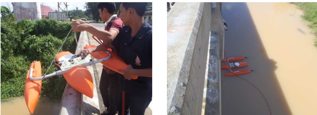
รูปที่ 4.14 การออกสนามเพื่อตรวจสอบความถูกต้องของหน้าตัดลำน้ำ
