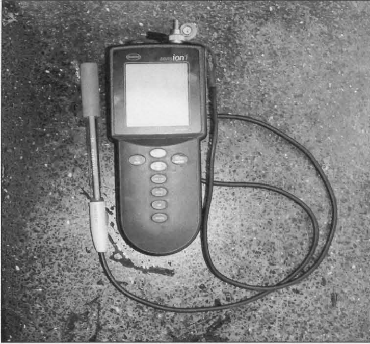
รูปที่ 3.4-5 อุปกรณ์วัดค่าค่าความเป็นกรด – ด่าง (pH meter)
