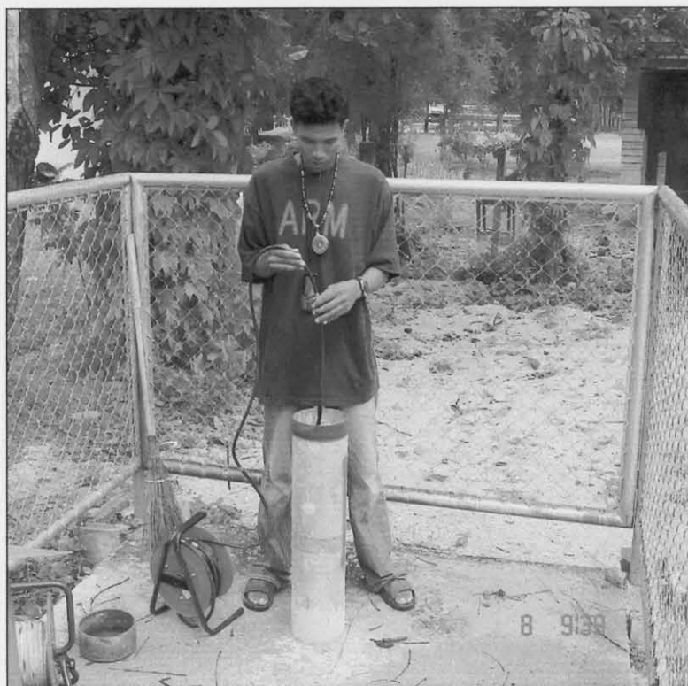
รูปที่ 3.4-3 วิธีการวัดระดับน้ำจากบ่อสังเกตการณ์
