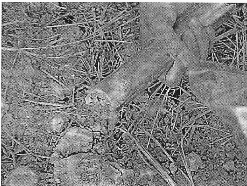
ภาพประกอบ 2-23 กระบอกลูมิเนียมที่ใช้ในการเก็บตัวอย่างดิน
