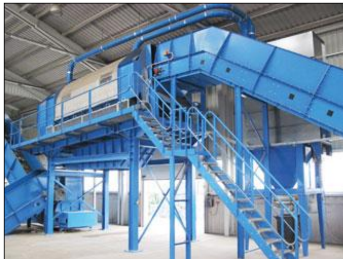
รูปที่ 1. เครื่องบดขยะก่อนนำเข้าเตาเผาจากบริษัทโดนาโซนิก (Donasonic) จากประเทศอังกฤษ
