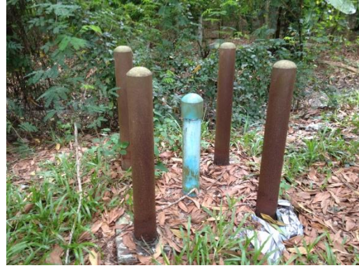
รูปที่ 4.4-6 ระบบติดตามตรวจสอบน้ำใต้ดิน
