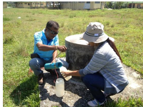
รูปที่ 4.5-7 การเก็บตัวอย่างน้ำจากระบบบำบัดน้ำชะขยะมูลฝอยและระบบติดตามตรวจสอบน้ำใต้ดิน
