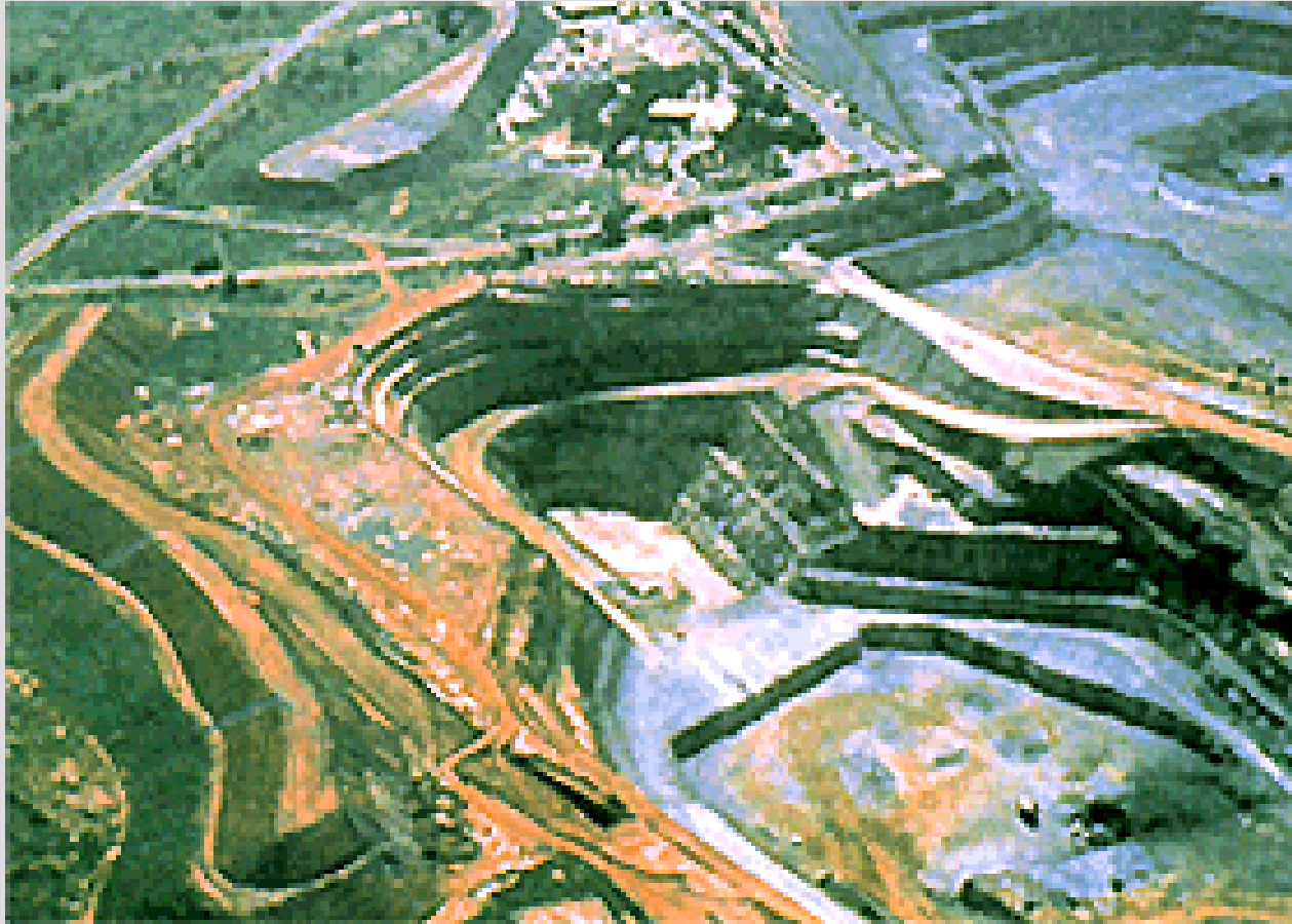
ภาพมองจากด้ายบน แสดงการใช้กองดินป้องกันผลกระทบจากการใช้วัตุระเบิดที่ เหมืองทองคำ Kalgoorlie Consolidated Gold Mines ในรัฐ Western Australia ประเทศออสเตรเลีย
