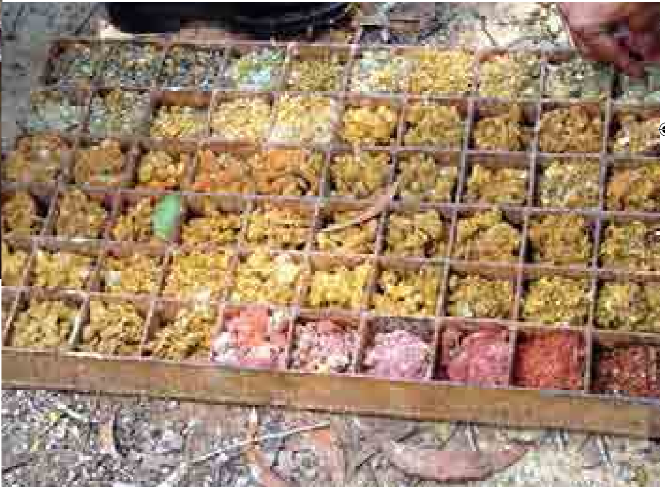
ตัวอย่างดินและหิน ในการขุดเจาะบ่อบาดาล จากชั้นดินที่ความลึกต่างๆ
