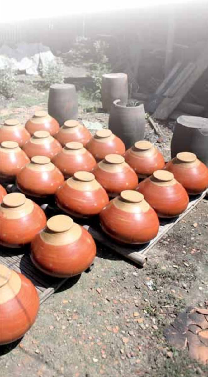
วัดฤทธิพิ ที่ชาวบ้านเหมืองกงใช้ในการทำดินเผา มาจากดินเหนียวท้องถิ่นจากอำเภอรอบนอก ส่วนกรรมวิธีการผลิตก็เป็นแบบโบราณ คือ ใช้มือในการขึ้นรูปดินเผา ในการหมุนแป้นหมุน การทำและตกแต่งลวดลายด้วยวัสดุอุปกรณ์ที่เรียบง่ายอย่าง หลอดตูดน้ำ การเผาในเตาเผาถ่านอริฐแบบดั้งเดิม ที่ยังคงใช้ฟืนเป็นเชื้อเพลิง
