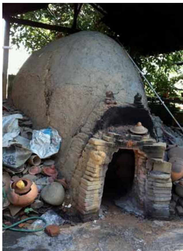
วัดฤทธิพิ ที่ชาวบ้านเหมืองกงใช้ในการทำดินเผา มาจากดินเหนียวท้องถิ่นจากอำเภอรอบนอก ส่วนกรรมวิธีการผลิตก็เป็นแบบโบราณ คือ ใช้มือในการขึ้นรูปดินเผา ในการหมุนแป้นหมุน การทำและตกแต่งลวดลายด้วยวัสดุอุปกรณ์ที่เรียบง่ายอย่าง หลอดตูดน้ำ การเผาในเตาเผาถ่านอริฐแบบดั้งเดิม ที่ยังคงใช้ฟืนเป็นเชื้อเพลิง
