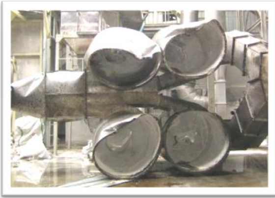
แสดงชุดไซโคลนเย็นทั้ง 4 ลูกขนาดกลาง แยกเป็นส่วนบนกับส่วนล่าง
