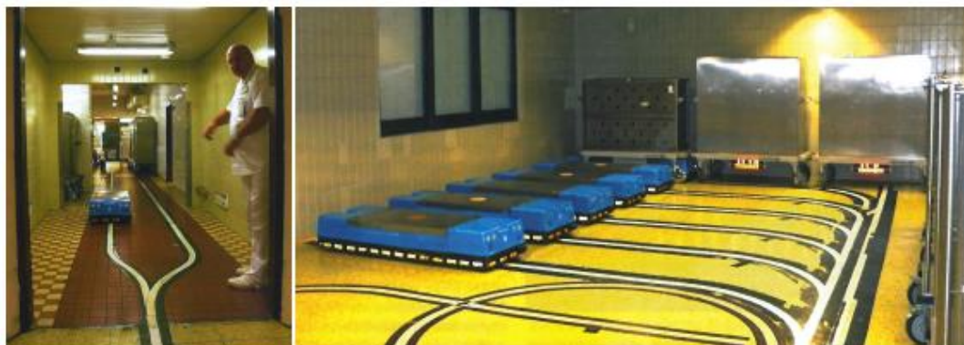
รูปที่ 2 แสดงการใช้งานระบบศูนย์กลางของหุ่นยนต์หลายตัวในโรงพยาบาล [ภาพจาก: Ondrej Stanek, David Obdrálek. Centralized multi-robot system. The Department of Software Engineering; 2012:4-12]
