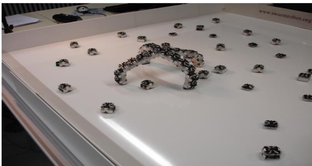
รูปที่ 1 แสดงการควบคุมหุ่นยนต์ที่สามารถประกอบตัวใหม่ได้ด้วยตัวเอง [ภาพจาก: Ondrej Stanek, David Obdrálek. Centralized multi-robot system. The Department of Software Engineering; 2012:4-12]
