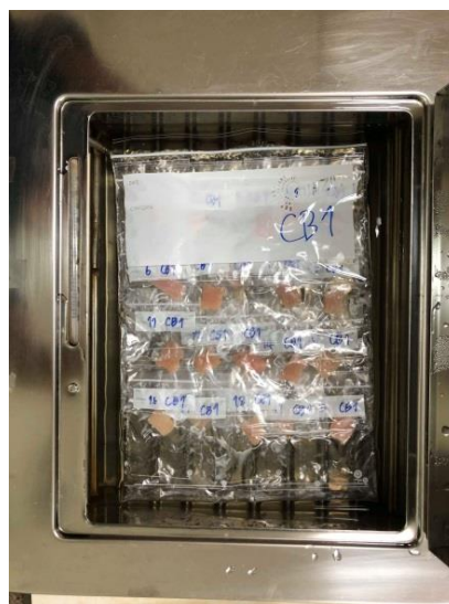
ภาพที่ 10 การวิเคราะห์หาค่าการสูญเสียน้ำเนื่องจากการทำให้สุก (cooking loss)
