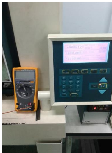
รูปที่ 3.8 อุปกรณ์วัดอุณหภูมิและปุ่มควบคุมเครื่องการทดสอบแรงดึง
