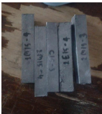
รูปที่ 3.4 ชิ้นงานที่ตัดมีขนาด 17 \times 100 \times 15 \text{ mm}^3
