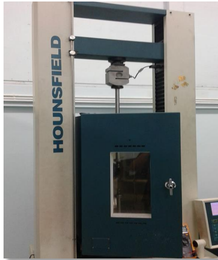
รูปที่ 3.6 เครื่องทดสอบแรงดึงยี่ห้อ Hounsfield
