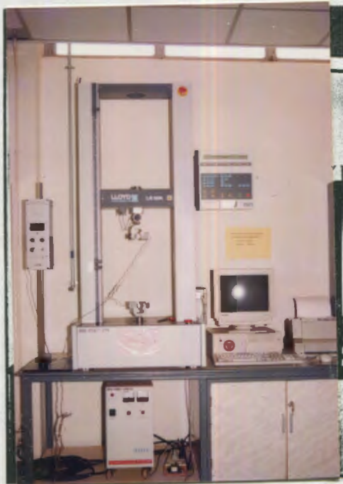
รูปที่ 8 เครื่องทดสอบความแข็งแรงของวัสดุ (universal testing machine)
