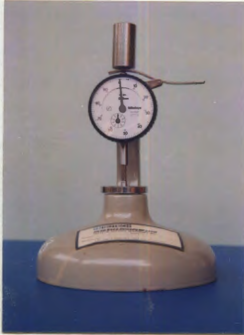
รูปที่ 7 ไมโครมิเตอร์ (Dial micrometer) สำหรับวัดความหนาของฟิล์ม
