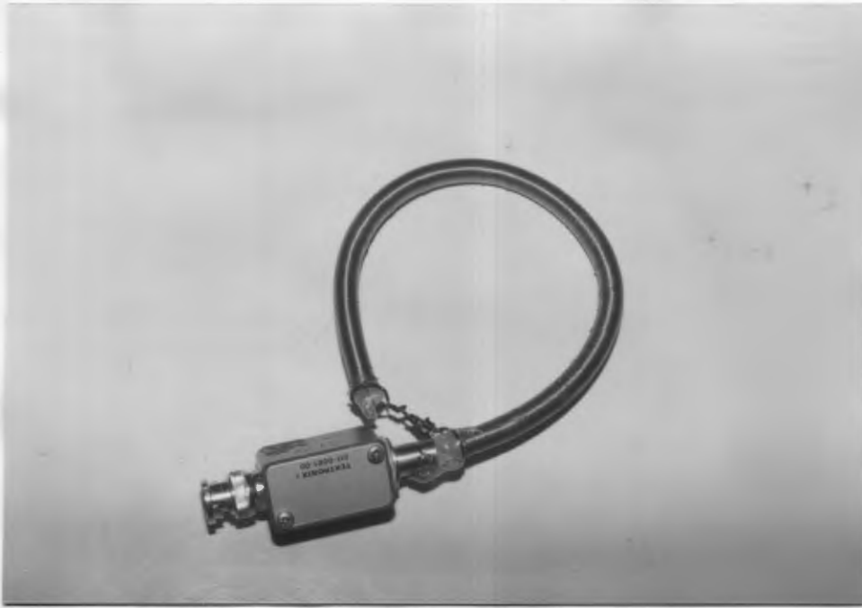
ภาพประกอบ 22 แสดงภาพถ่ายหัววัดกระแสไฟฟ้า
