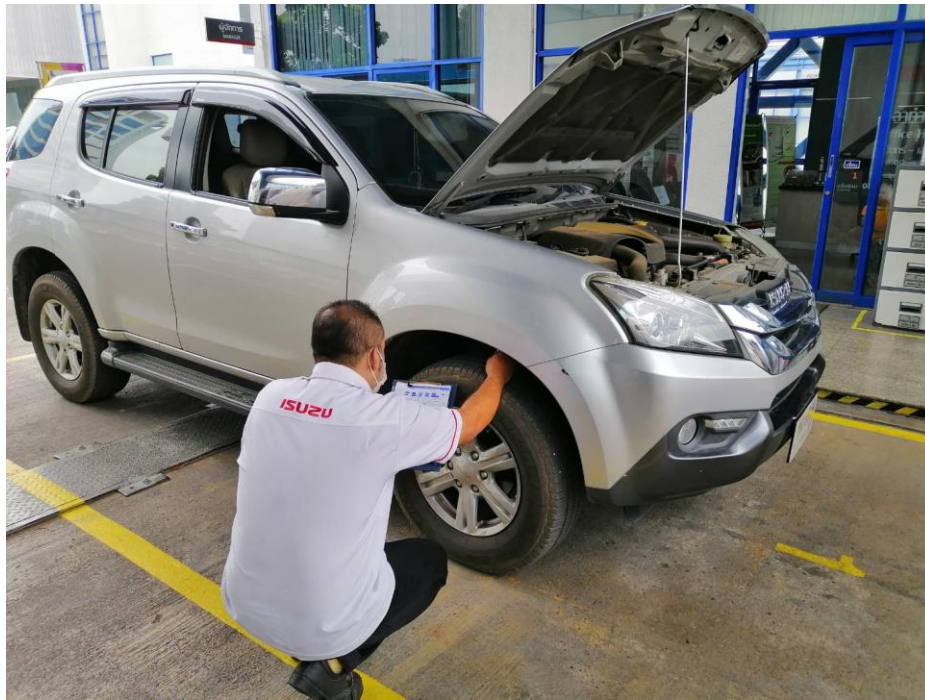
ภาพที่ 4.10 การตรวจเช็คสภาพรถยนต์ตามระยะทาง 30,000 กิโลเมตรและ 40,000 กิโลเมตร
