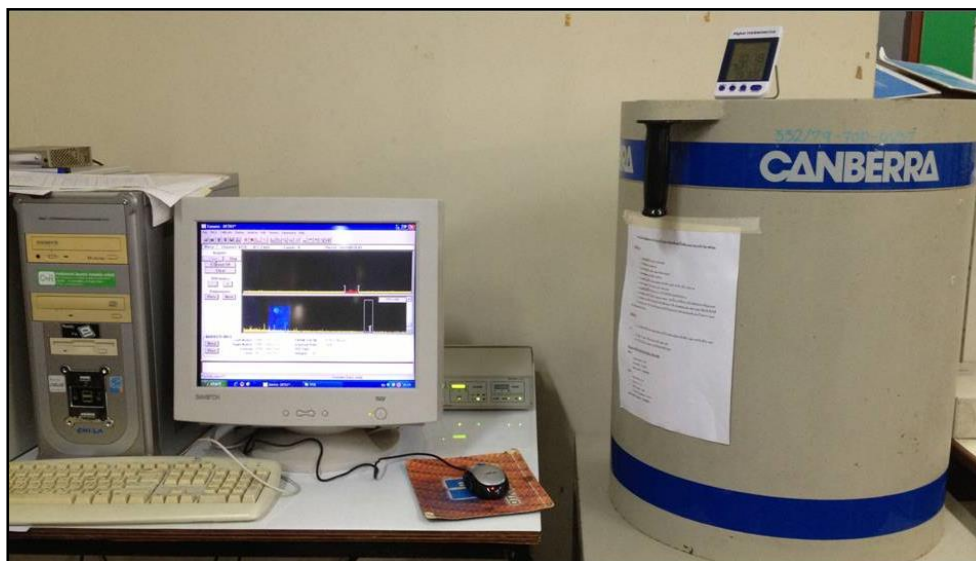
รูปที่ 5 ระบบวิเคราะห์สเปกโตรมิเตอร์รังสีแกมมาที่ใช้ในงานวิจัย
