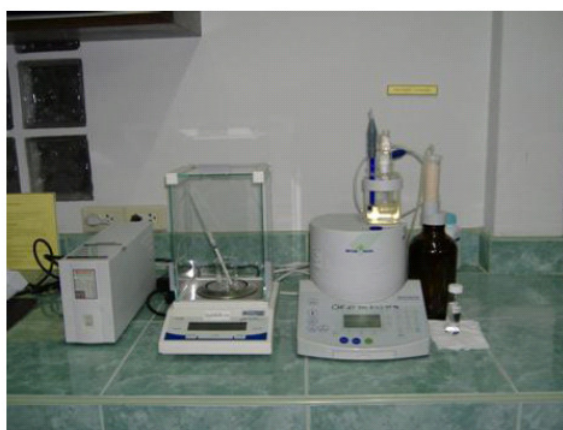
ภาพประกอบที่ 17 เครื่อง Karl Fisher coulometer ของบริษัท Mettler รุ่น DL39
