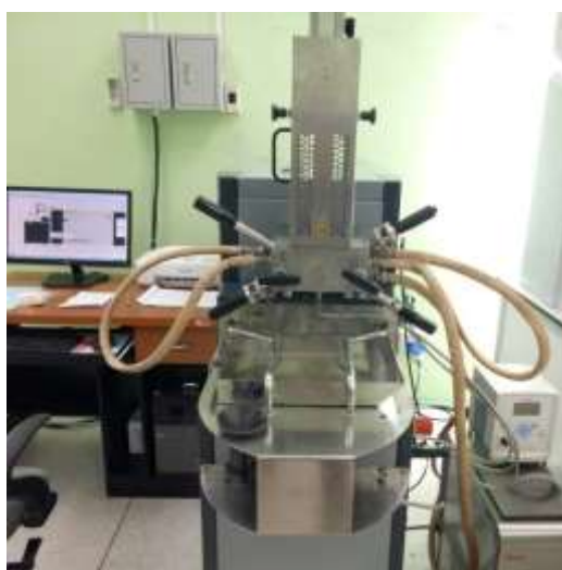
รูป 2.29 เครื่องผสมยางระบบปิด (Internal Mixer) [41]
