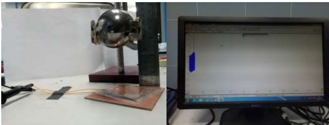
รูป 3.22 แสดงการทดสอบวัดการกำเนิดความต่างศักย์ไฟฟ้าที่มีการให้แรงกระแทก
