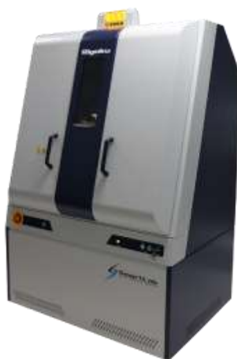
รูป 3.11 แสดงเครื่องวิเคราะห์การเลี้ยวเบนของรังสีเอ็กซ์ (X-Ray Diffractometer : XRD)[42]
