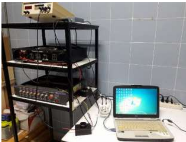
รูป 3.17 เครื่องวัดสมบัติเพอร์โรอิเล็กทริกโดยอาศัยวงจร Sawyer-Tower
