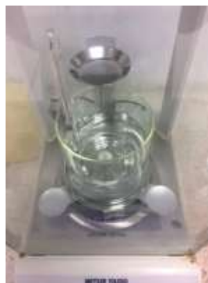
รูป 3.13 อุปกรณ์สำหรับการหาความหนาแน่นโดยใช้หลักการของอาร์คิมิดีส
