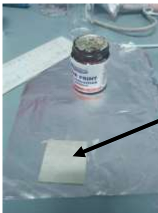
รูป 3.21 แสดงลักษณะการตากาวเงินลงบนผิวชิ้นงาน
