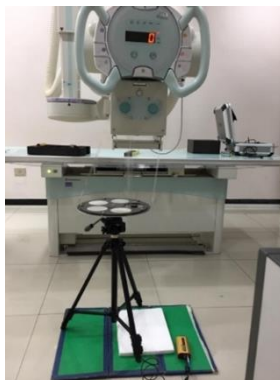
รูปที่ 3.11 เครื่องวัดการดูดกลืนรังสีเอ็กซ์ (X-ray detector)
