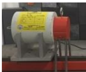
รูปที่ 3.13 แหล่งกำเนิดรังสีแกมมา และแผนภาพโครงสร้างแหล่งกำเนิดรังสีแกมมา
