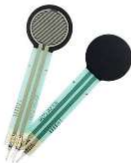
รูปที่ 3-14 เซ็นเซอร์ตรวจวัดแรงบีบ (Force sensor resistor) [34]
