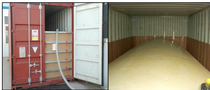
ภาพที่: 2.4 การบรรจุน้ำยางในถุงขนาดใหญ่ (Flexi Bag)
