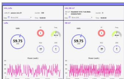
รูปที่ 5 Node-Red Dashboard เปรียบเทียบข้อมูลจาก 2 protocol
