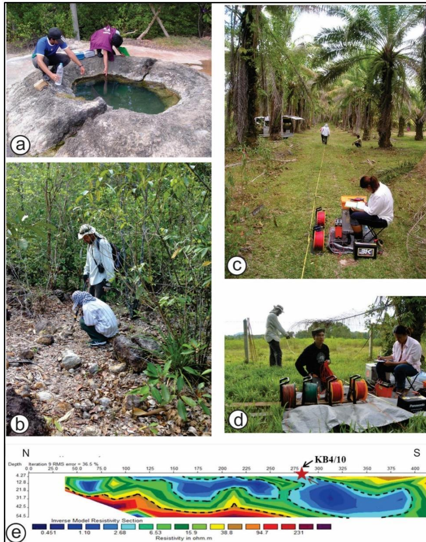
รูปที่ 7 a) การเก็บตัวอย่างน้ำเพื่อวัดผลทางธรณีเคมีที่บ่อน้ำพุร้อน KB4/10 และการเกิดแผ่นหินปูนรอบบ่อน้ำพุร้อน b) การสำรวจทางธรณีวิทยา มีหินทรายในพื้นที่บ่อน้ำพุร้อน c) การสำรวจสภาพต้านทานไฟฟ้าแบบยังลิกแนวตั้งในพื้นที่ศึกษา d) การสำรวจแบบสร้างภาพตัดขวางสภาพต้านทานไฟฟ้า e) ภาพตัดขวางสภาพต้านทานไฟฟ้าที่บริเวณบ่อน้ำพุร้อน KB4/10
