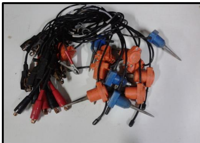
รูปที่ 2.1 เครื่องมือที่ใช้สำรวจวิธีคลื่นไหวสะเทือน a) เครื่อง Geometric SmartSeis b) ค้อนและแผ่นเหล็ก และ c) จีโอโฟน
