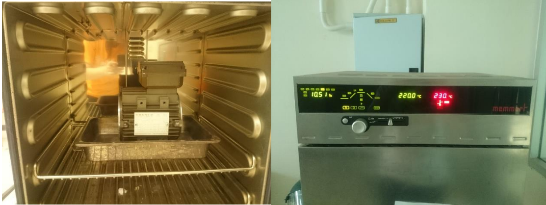
ภาพประกอบ 3-4 การอบมอเตอร์ที่อุณหภูมิ 220 องศาเซลเซียส เพื่อกระตุ้นมอเตอร์ ด้วยความร้อน
