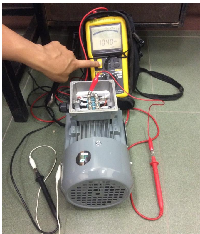
ภาพประกอบ 3-3 การวัดค่าความต้านทานฉนวนไฟฟ้าด้วยเมกเกอร์
