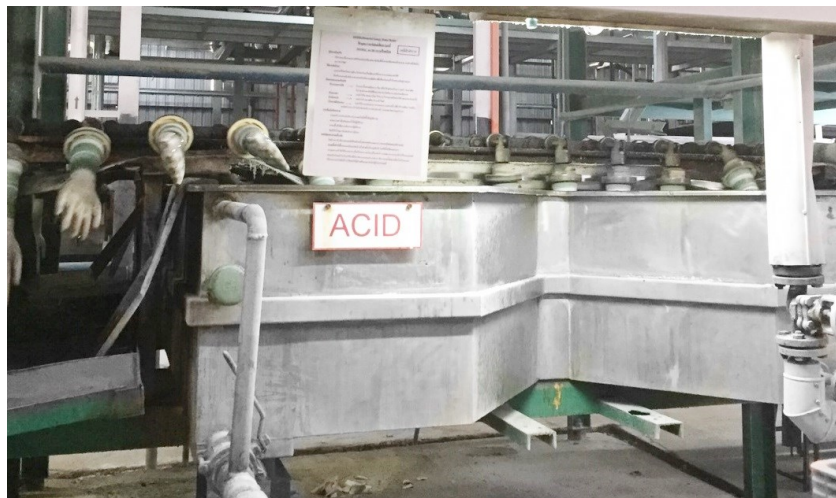
รูปที่ 4.5 การล้างทำความสะอาดเบ้ามือด้วยกรด
