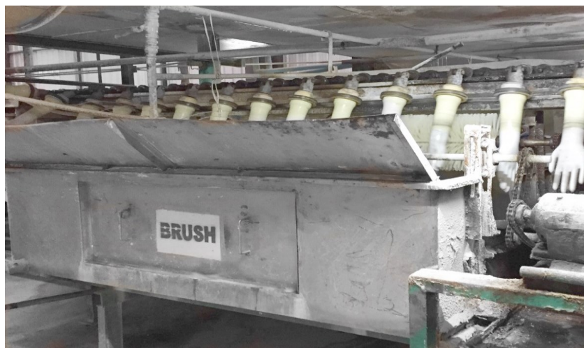
รูปที่ 4.7 การทำความสะอาดเบ้ามือด้วยชุดลูกกลิ้งแปรงขัด
