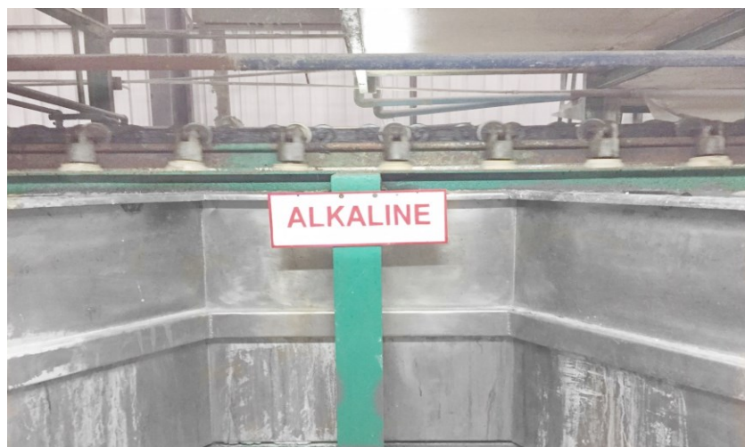
รูปที่ 4.6 การล้างทำความสะอาดเบ้ามือด้วยด่าง
