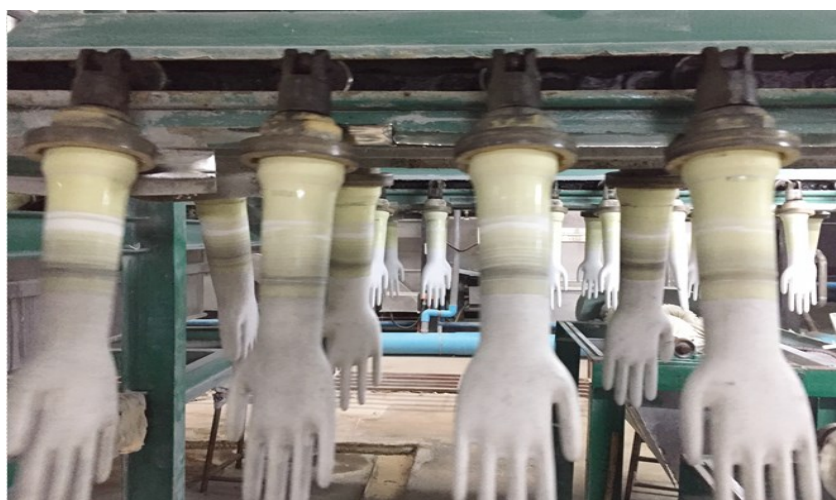
รูปที่ 4.4 การติดตั้งเบ้ามือ
