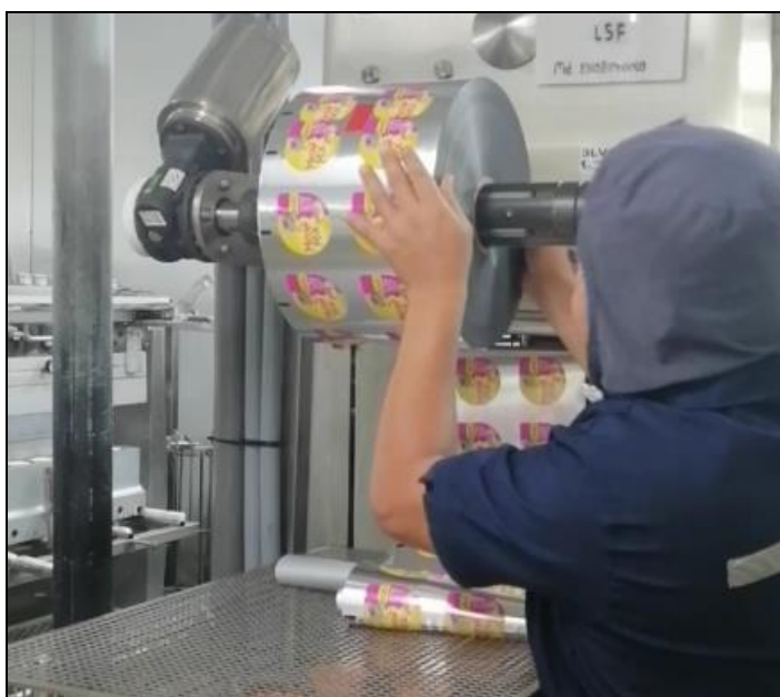
รูปที่ 4.26 การนำม้วนฟิล์มใหม่ใส่เครื่องปิดผนึก
