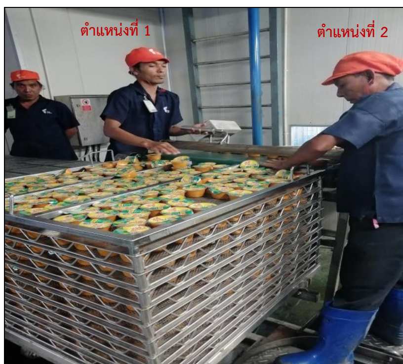
รูปที่ 4.16 ตำแหน่งการยืนของพนักงานเรียงถ้วยลงตะกร้าฆ่าเชื้อ
