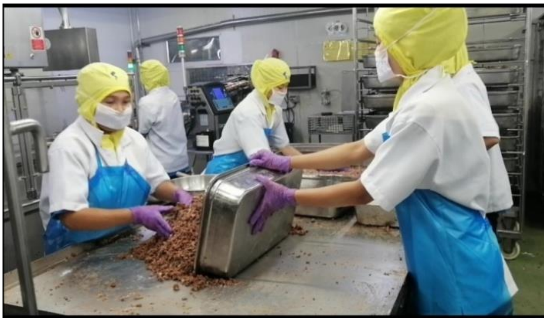
รูปที่ 4.14 การคลุกผสมวัตถุดิบให้เป็นเนื้อเดียวกันและการบรรจุใส่ถาด
