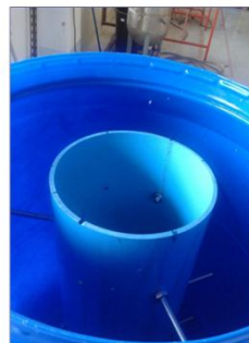
ถังแยกมีท่อแนวตั้ง (air lift tube) ตรง
