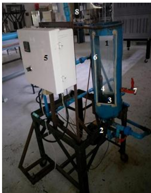
รูปที่ 12 รูปถ่ายแสดงการดัดแปลงถังแยกเพื่อให้สามารถถ่ายภาพฟองอากาศได้
