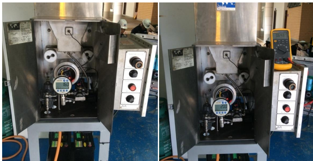
ภาพประกอบ 4-8 การติดตั้ง TEG และเครื่องมือวัดเพื่อทำการทดลอง
