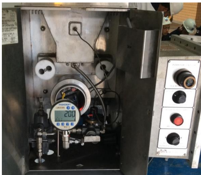
ภาพประกอบ 3-13 การตั้งค่าความดันก๊าซของ TEG ใช้ Digital pressure guage เป็นตัวแสดงผล
