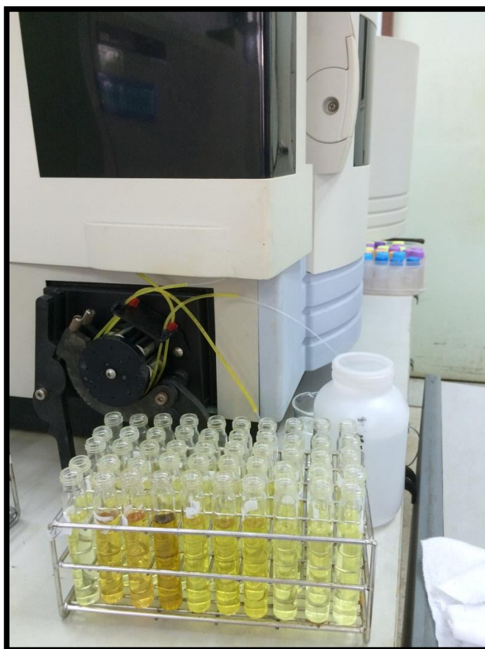
รูปที่ 10 การเตรียมสารละลายที่ได้เพื่อวิเคราะห์หาปริมาณตะกั่ว แคดเมียม และโครเมียม โดยใช้ เครื่อง ICP-OES รุ่น optima 4300 DV
