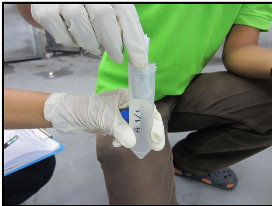
รูปที่ 6 การเก็บผ้าเช็ดทำความสะอาดผิวแบบเปียก (moist wipes) ที่เก็บตัวอย่างฝุ่นเสร็จเรียบร้อยแล้วในหลอดพลาสติกชนิด polypropylene
