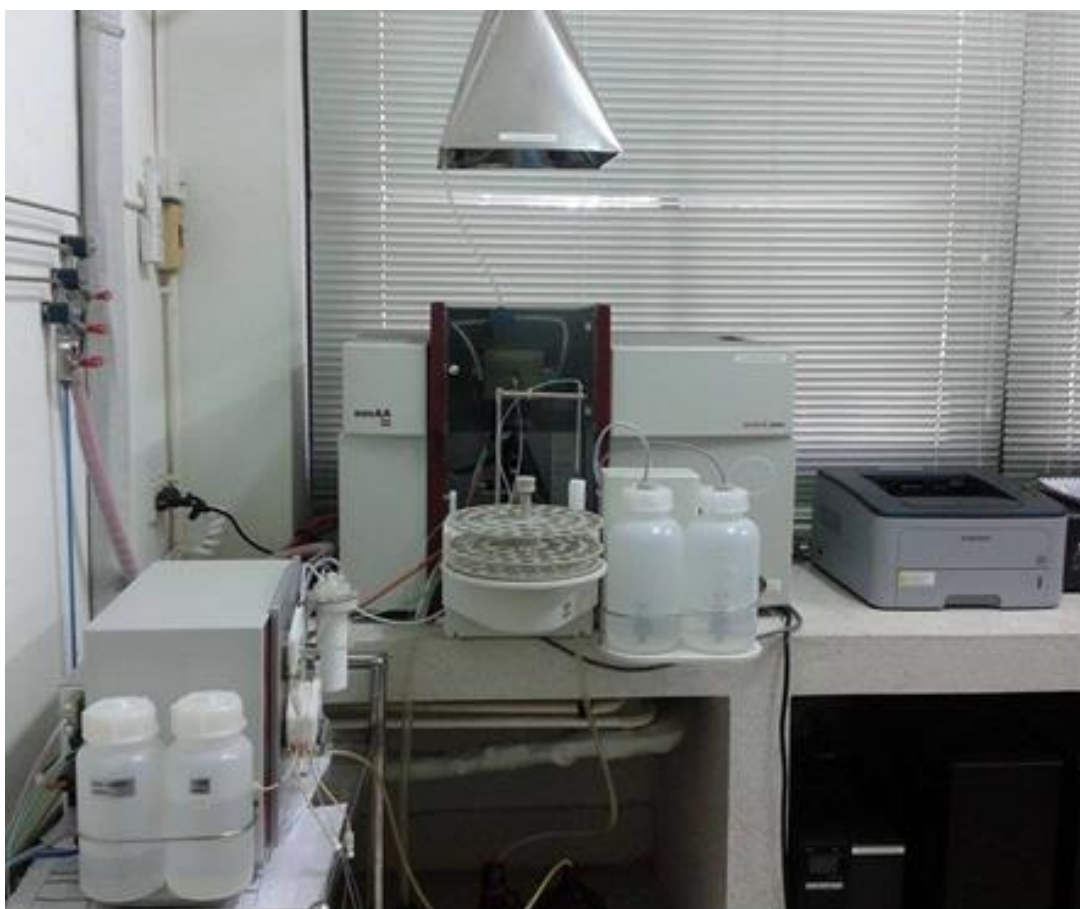
ภาพที่ 2.1 อะตอมมิก แอบซอร์พชัน สเปกโตรมิเตอร์ เครื่องยี่ห้อ Analytikjena รุ่น NovAA 350 คู่กับเทคนิคไฮโดรด์ เจนเนอเรชัน รุ่น HS 60
