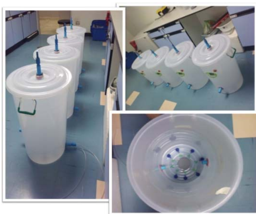
ภาพที่ 17 ลักษณะภายในถังปฏิกริยาที่ใช้ทดลองของระบบ SBR ที่ศึกษา
