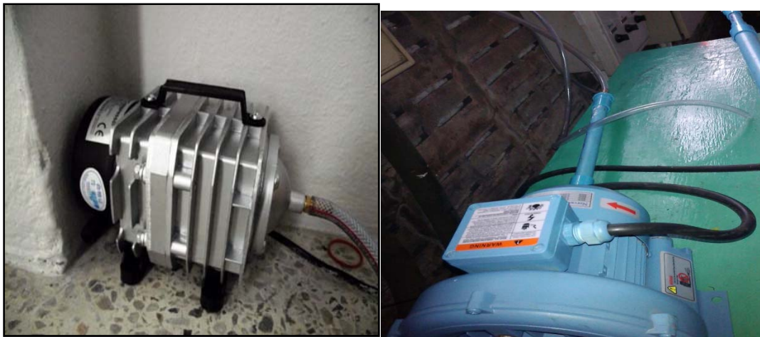
ภาพที่ 18 (1) ปัมป์สำหรับให้อากาศ (aeration) และ (2) ปัมป์สำหรับป้อนอากาศเสียเพื่อป้อนเข้าไปในชุดทดลอง SBR (R3 และ R4) และชุด R2
