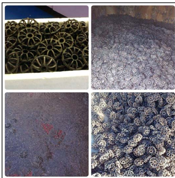
ภาพที่ 31 ลักษณะ media ที่ใช้และตะกอนที่เกาะติดที่ตัวกลาง (media) ของโรงงานที่ศึกษา
