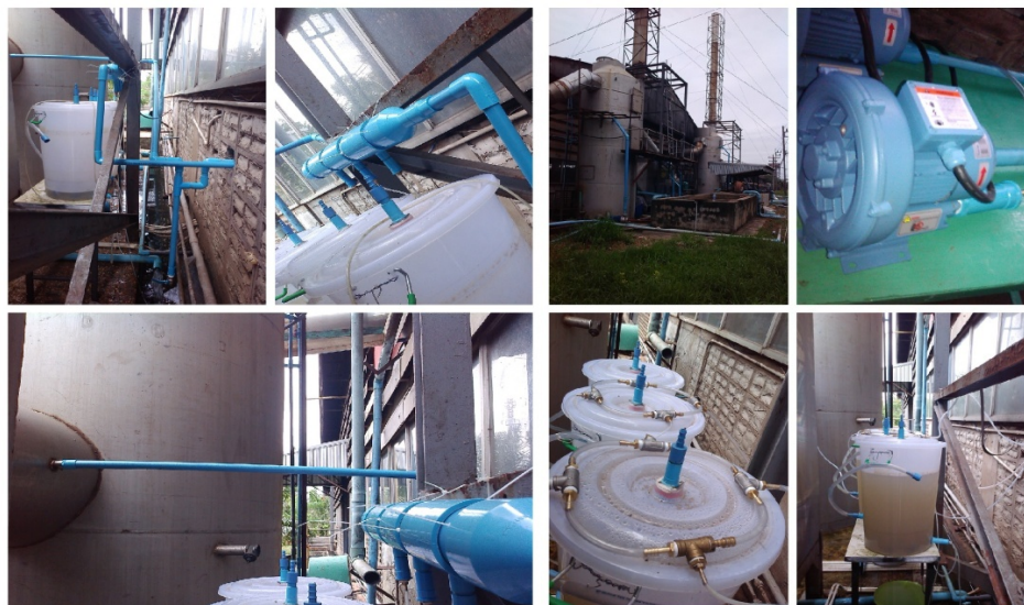
ภาพที่ 20 ลักษณะชุดทดลองของระบบ SBR ที่ใช้ในการศึกษา
