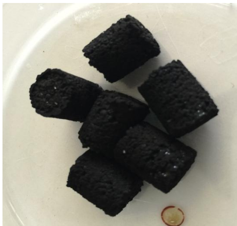
ภาพประกอบที่ 3-5 ตัวดูดซับแบบอัดเม็ดที่ได้จากถ่านกัมมันต์ทางการค้า
