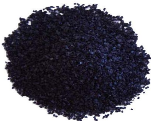
ภาพประกอบที่ 2-2 ถ่านกัมมันต์ทางการค้าผลิตจากกะลามะพร้าว
