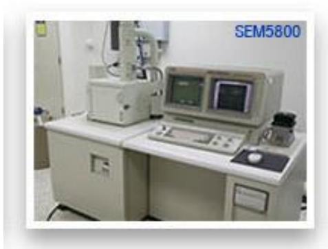
รูปที่ 3.6 เครื่องจุลทรรศน์อิเล็กตรอนแบบส่งกราดรุ่น SEM5800 (ภาพจากศูนย์เครื่องมือ วิทยาศาสตร์มหาวิทยาลัยสงขลานครินทร์)
