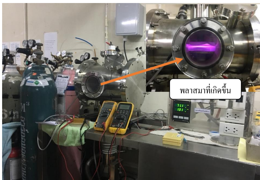
รูปที่ 3.5 เครื่องกำเนิดรังสีพลาสมาแบบ Low Pressure DC Glow Discharge Plasma
