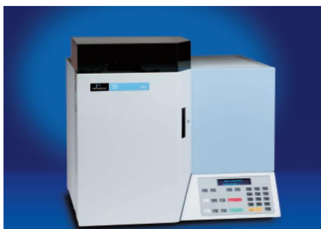
รูปที่ 2.12 เครื่องมือ 2400 CHN Elemental Analyzer ของบริษัท Perkin Elmer
