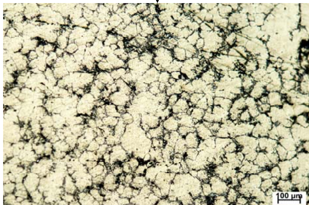
รูปที่7.แสดงลักษณะเกรนในบริเวณแนวเชื่อม(WM)ที่รอบ การหมุนดอกสว่านรอบ (a)1,100 รอบ/นาที,(b)1,750 รอบ/นาที,(c)2,200 รอบ/นาที
