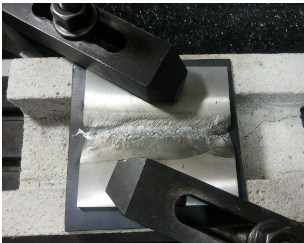
รูปที่ 3.16 ชิ้นงานที่ปล่อยให้เย็นตัวภายใต้บรรยากาศปกติหลังการเชื่อม
