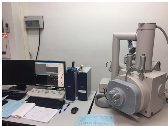
รูปที่ 3.11 กล้องจุลทรรศน์อิเล็กตรอนแบบส่องกราด
