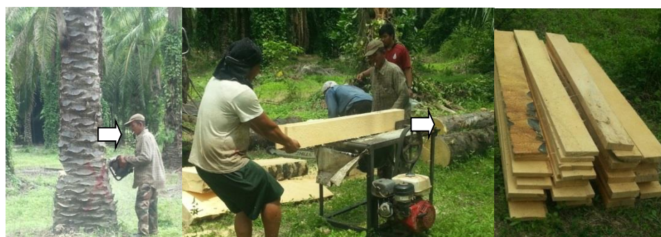
ภาพที่ 5 กระบวนการแปรรูปไม้ปาล์มน้ำมัน
