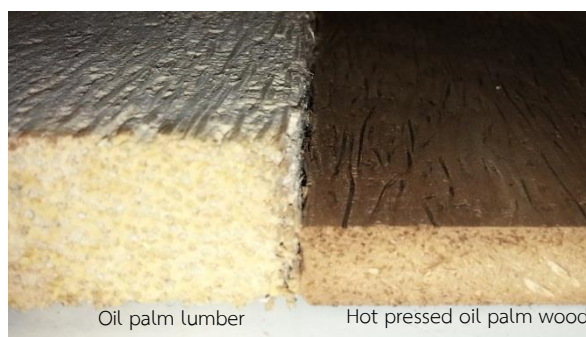
ภาพที่ 6 ไม้ปาล์มน้ำมันแปรรูปและไม้ปาล์มน้ำมันอัดด้วยอุณหภูมิ 200 องศาเซลเซียส
