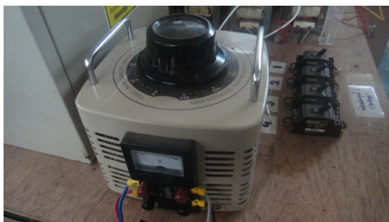
รูปที่ 4.3 ชุดทดลองที่ใช้ในการควบคุมกำลังวัตต์ของไมโครเวฟ
