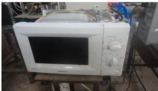
รูปที่ 4.2 ชุดทดลองที่ใช้ในการอบแห้งผลปาล์มด้วยไมโครเวฟ
