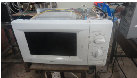
รูปที่ 3.1 ตู้อบไมโครเวฟที่ใช้ในการอบแห้งผลปาล์มด้วยไมโครเวฟ
